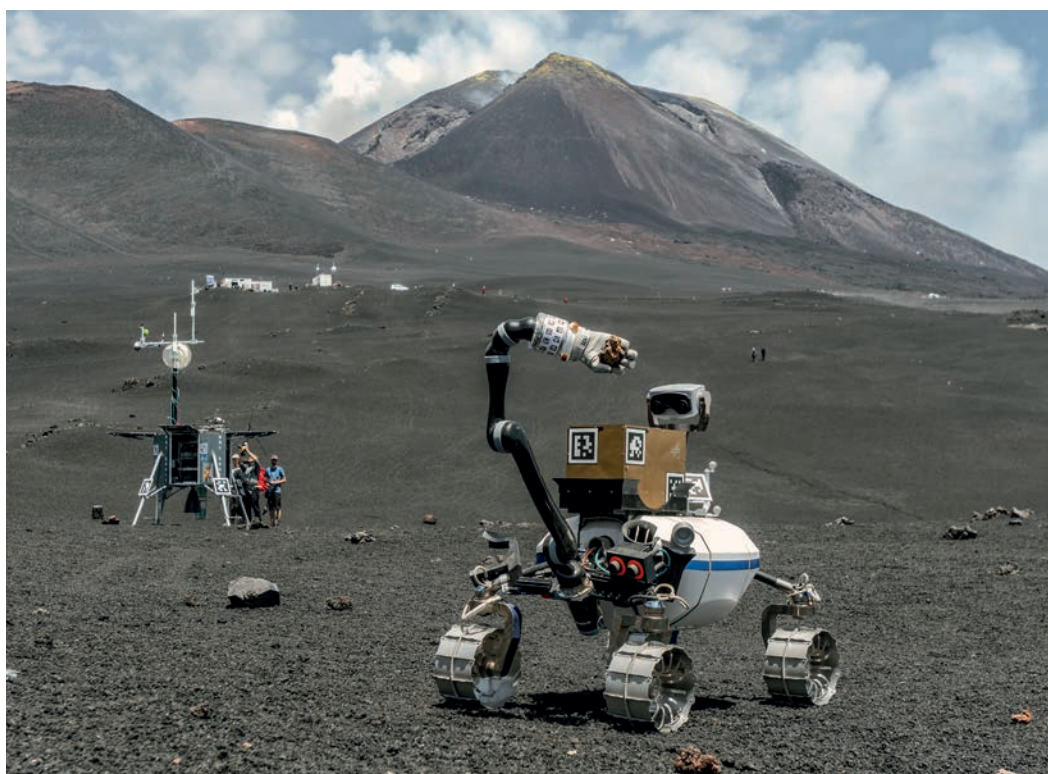
Getestet. Wie verhalten sich Roboter auf dem Mond? Schaffen sie es, Proben und Daten zu sammeln? Diese komplexen Funktionen müssen getestet werden, bevor ein Rover in den Weltraum darf, etwa hier am Ätna.
