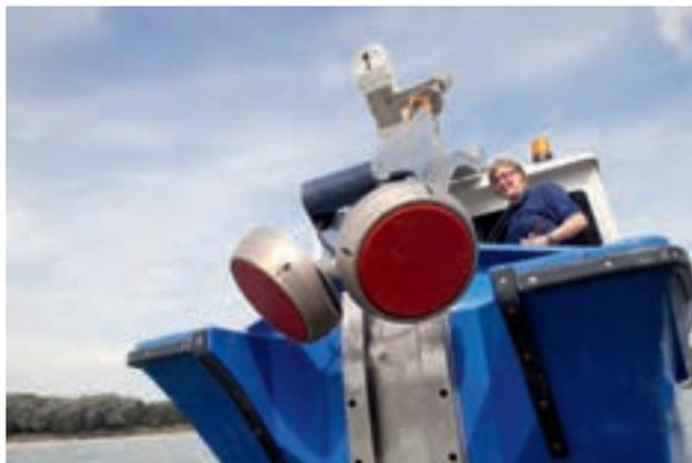
**Messarbeiten.** Die Beschaffenheit des Grundes zu kennen ist wichtig, um einen Strom wie die Donau sicher befahren zu können. Daher muss die viadonau den Gewässerzustand ständig im Auge behalten. Mit Echolotgeräten ausgestattete Messschiffe machen regelmäßig Aufnahmen des Sohlegrundes und führen Vermessungen der Ufer und Hochwasser-Retentionräume durch.
